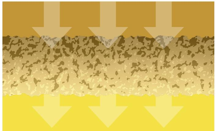
Der Prime Filtereinsatz fängt Partikel ab UND adsorbiert gelöste Verunreinigungen für ein sauberes, frischeres und länger haltbares Fett.
